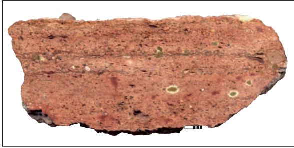
Abb. 5: Undeutlich geschichteter Ignimbrit mit zonenweiser Anreicherung von Gesteinbruchstücken, einige akzessorische Gesteinbruchstücke verursachen Reduktionshöfe. Aus einem temporären Aufschluss in der Ortslage Unkersdorf (Unkersdorf-Tuff, Unkersdorf-Formation, Maßstab entspricht 1 cm). Foto: U. Hoffmann.
